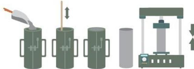
La prueba de compresión implica aplicar fuerza de compresión al concreto hasta que falla, lo que proporciona información sobre su capacidad para soportar cargas verticales y asegura la integridad estructural.
